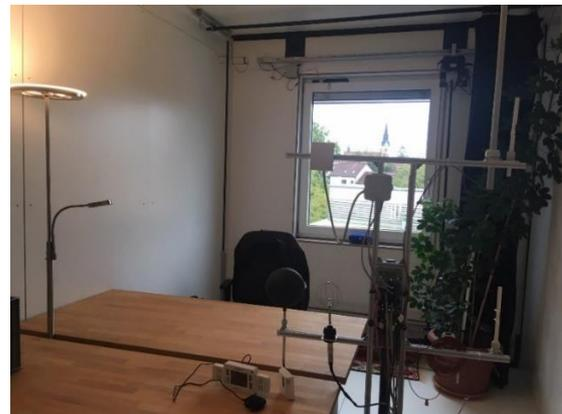
Abbildung 4-7: Schema des Messbaumes zur Erhebung raumklimatischer und CO<sub>2</sub>-Daten in der Prüfbox
